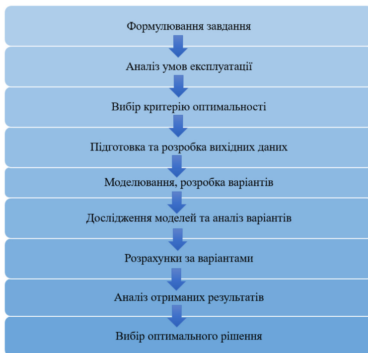
Рис. 3. Загальна схема вирішення оптимізаційних завдань організації перевізного процесу та управління роботою флоту
